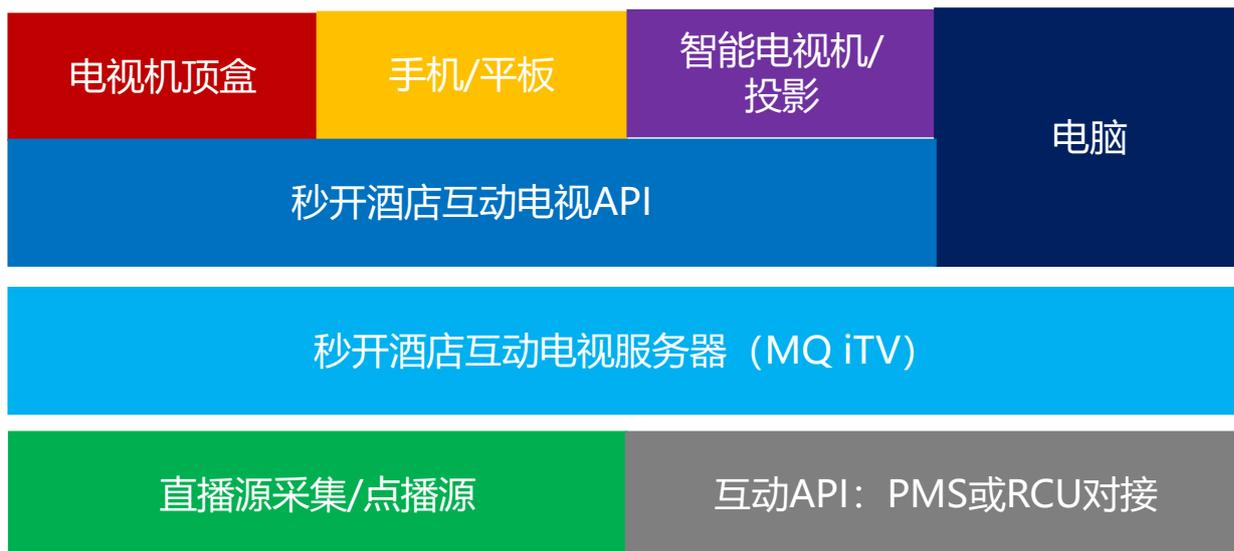
系统基于HLS流媒体技术开发，能部署在任何IP网络上（包括无线网络），适应性强，配合专用APP，适用于所有带安卓系统终端播放设备（机顶盒、智能电视、投影电视、智能手机、平板电脑等）。
